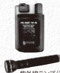
紫外線ランプ(油漏れ診断)
